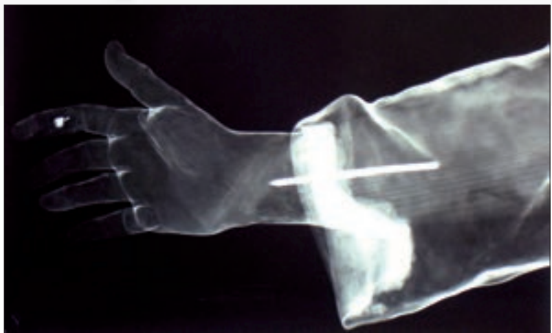
Radiografía de la mano derecha. Destaca el clavo a modo de espiga que une la mano al brazo. Se evidencia un tornillo en el dedo índice.
